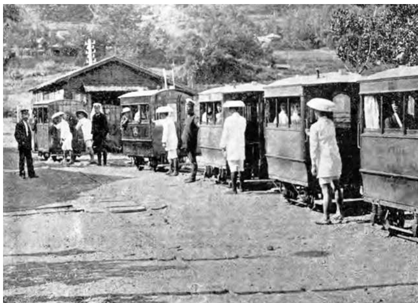
2～3人の車夫が小さな客車を押して運行した「豆相人車鉄道」(610mm軌間)。のちに762mmに改軌して蒸気化、社名も「熱海鉄道」としている(『日本之名勝』より 所蔵：国立国会図書館)
